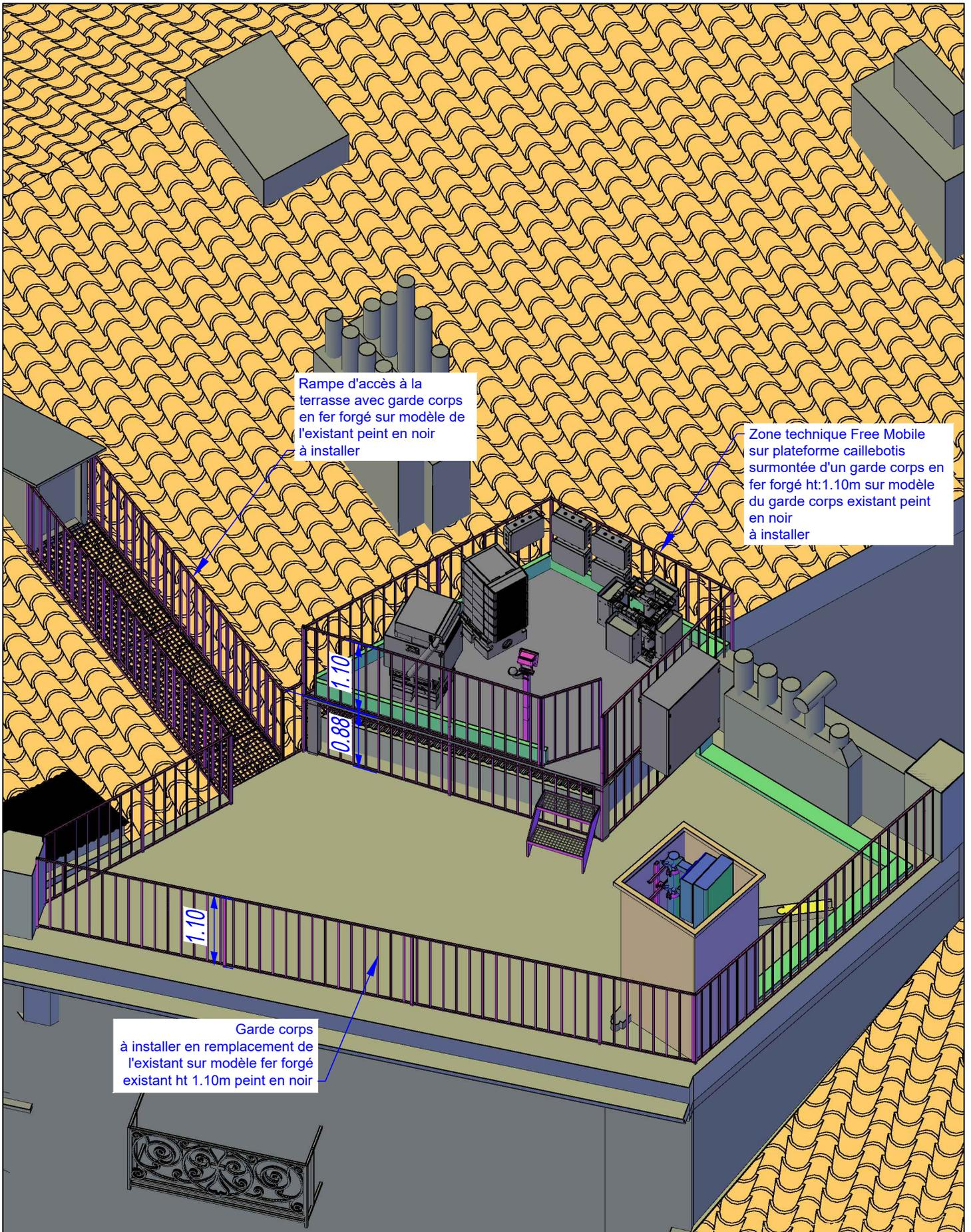
Rampe d'accès à la terrasse avec garde corps en fer forgé sur modèle de l'existant peint en noir à installer
