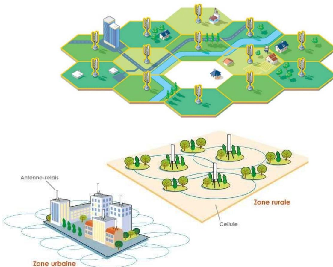
**L'antenne-relais émet des ondes dans une direction privilégiée. Ce faisceau peut être comparé à celui d'un phare qui éclaire la mer.** Les faisceaux principaux de l'antenne sont directifs et très fins (6 degrés environ) dans le plan vertical. **L'intensité du faisceau diminue très rapidement (en fonction du carré de la distance) en s'éloignant de l'émetteur.** Cf. schéma ci-dessous à titre indicatif.
