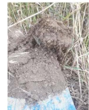
Figures 14, 15 et 16 avec et dans l'ordre : refus de test-bêche pour le premier test, 2ème test-bêche, mauvaise structure de sol sur 2ème test bêche illustrée par la non tenue de la motte excavée.
