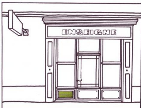
↖ ICI, un système de ventilation intégré en allège d'une devanture.
