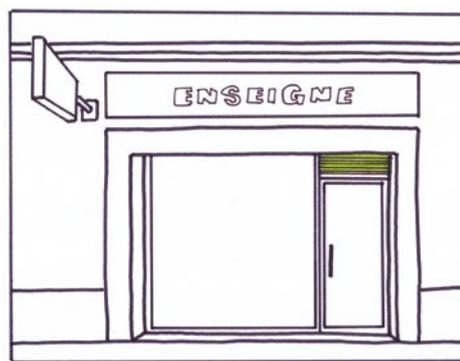
↖ ICI, un système de ventilation intégré en imposte d'une devanture.
