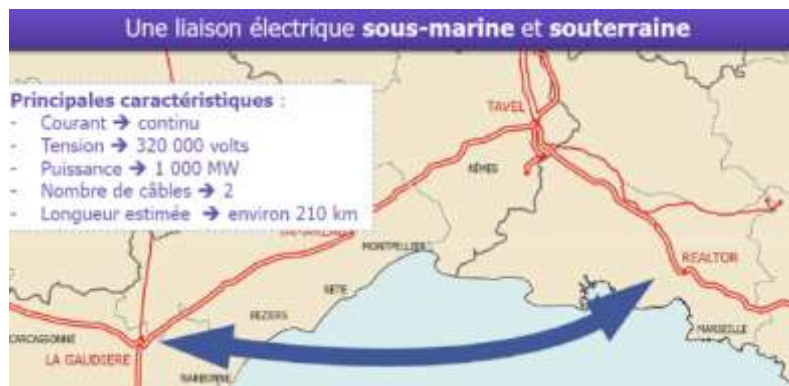
Figure 51 : Schéma du projet de ligne électrique sous-marine Midi-Provence
